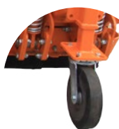
Koło podporowe z bezstopniową regulacją
