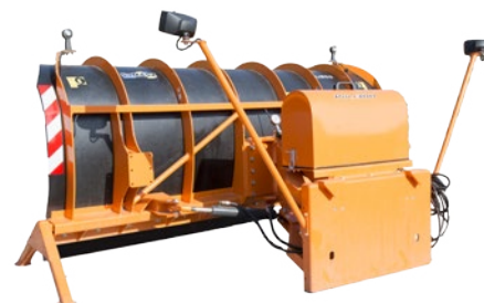
Własny niezależny układ hydrauliczny (POLI H)
